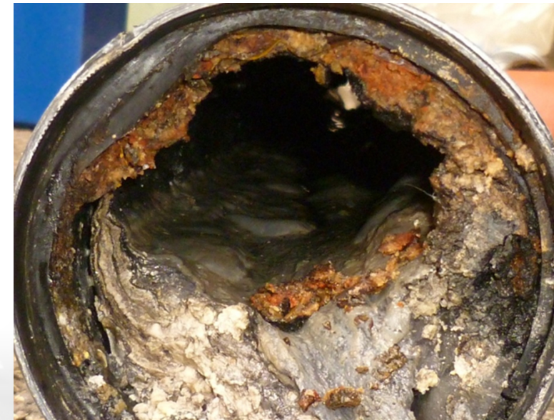
Störfall! Ohne Abscheider setzt sich Fett im Rohr ab!
